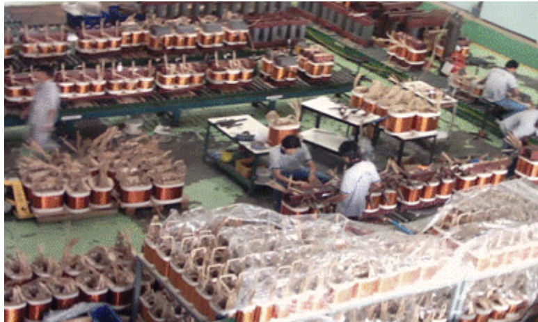
ภาพที่ 3 ชั้นงานระหว่างผลิตที่รออยู่หน้าสถานีประกอบไส้หม้อแปลง
