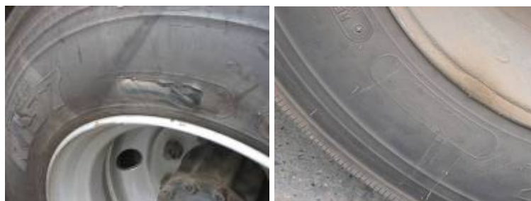
รูปที่ 3.4 Tag ชำรุดเสียหายจากการติดตั้งไม่ได้มาตรฐาน
