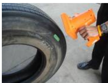
รูปที่ 3.1 แสดงการทดสอบระยะการอ่านและตำแหน่งติดป้ายอาร์เอฟไอดี
