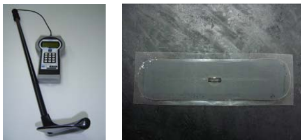
รูปที่ 3.5 เครื่องอ่านและป้ายอาร์เอฟไอดีที่ใช้ในโครงการนำร่องในระยะที่ 2
