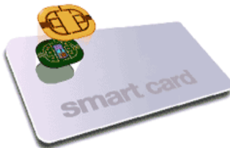
รูปที่ 2 : สมาร์ทการ์ดแบบมีการสัมผัส (Contact Cards)
