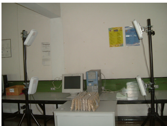
ภาพที่ 4-5 สรุปวิธีการติดตั้ง RFID เพื่อให้อ่านได้ดีที่สุดในห้องปฏิบัติการ
